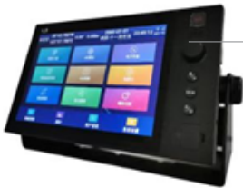
北斗短报文终端（船舱内安装）
